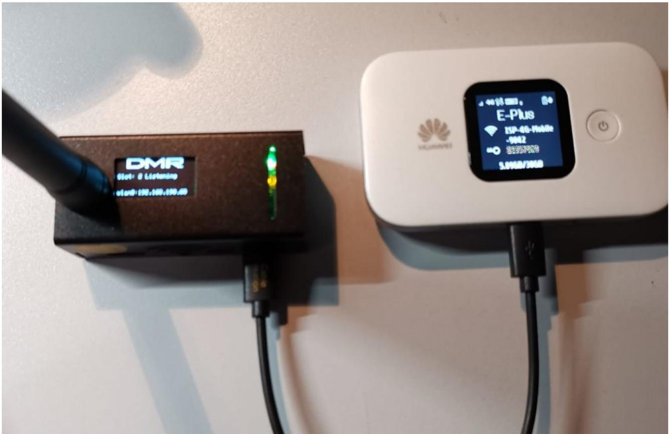
Und schon ist DIGITAL in der Hosentasche verstaut. Wer sich dann noch eine WSIM Karte einlegt, hat alle Netze (*Telekom, Telefónica, Vodafone & Drillisch 1&1* mit 2G, 4G oder 5G ) je nach Router in DE verfügbar oder kann in Europa in allen Netzen seine digitalen Funk nutzen.
