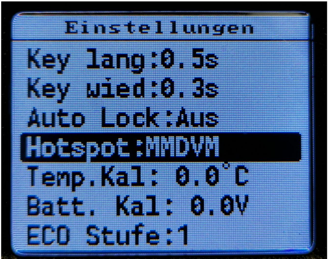
Dann wird der Raspberry Pi mit dem aktuellen Pi-Star 4.2.x gestartet. Dort wird über Konfiguration der MMDVM Port (*ttyUSB0* oder *ttyAMA0* , je nach PiStar Version ) und zudem das **Radio/Modem Typ** ausgewählt und **OpenGD77 DMR hotspot (USB)** ausgewählt (welches mit der Suche schnell gefunden wird).
